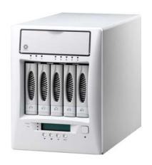
为满足企业存储环境快速成长需求,许多的企业均在寻求更容易、更合乎成本的方法来管理数据,网络存储设备NAS(Network Attached Storage)可以让多个用户透过网络连接文件服务器,存取同一份档案内容,达到档案资源共享,其跨平台的设计可有效的整合不同的操作系统(Windows、UNIX / Linux、Apple),节省大量的硬件购置成本,并让档案共享更便利,以达到增进企业的竞争优势。
