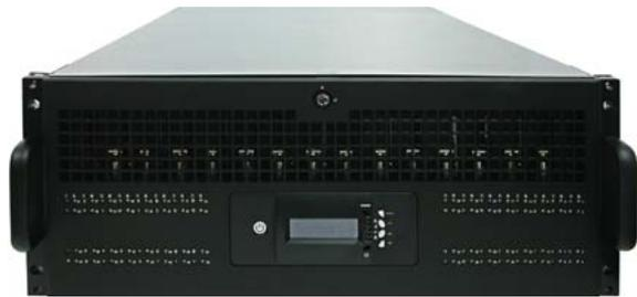
EP-4643系列的磁盘阵列容错系统提供了新一代的容错方案，采用了高速光纤(8Gb FC-AL)接口连接主机端(Host)，可在4U的机架空间内安装高达64颗可热插入的SAS II/SATA III的硬盘，提供了大容量、高效能及高扩充性的优异特色；为提升企业对存储设备的信赖度，除支援磁盘阵列等级0, 1, 10(1E), 3, 5, 6, 30, 50, 60 及 JBOD外，全系列并支持双控制器(Dual Controller)以提供更好的容错能力，实现企业对数据存储的要求。
